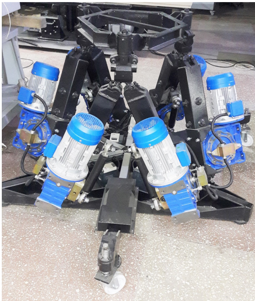
Характеристики шестистепенной динамической платформы
